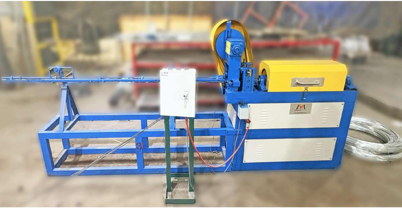
La Maquina Enderezadora y Cortadora, endereza automáticamente el alambre de acero inoxidable, alambre galvanizado, alambre de aluminio, alambre de cobre y cortar automáticamente de acuerdo con la longitud preestablecida.
