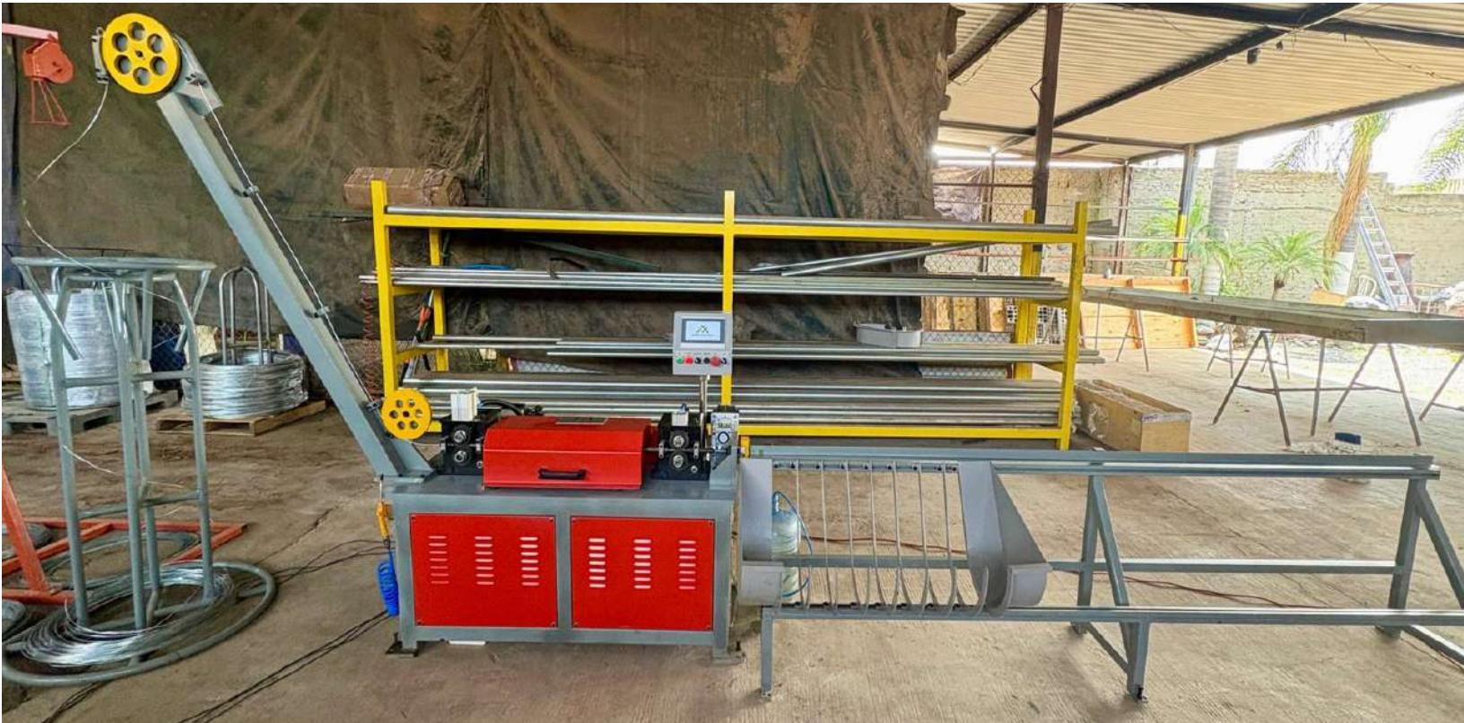
La Maquina Enderezadora y Cortadora, endereza automáticamente el alambre de acero inoxidable, alambre galvanizado, alambre de aluminio, alambre de cobre y cortar automáticamente de acuerdo con la longitud preestablecida.
